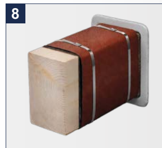
8 Fuge mit Steinwollfüllung und Acrylabdichtung
